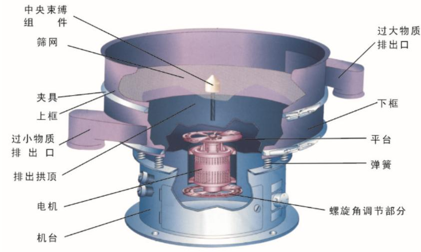
为什么圆形振动筛那么受欢迎？余盈工业来给您讲解圆形振动筛有哪些优点？1. 体积小，重量轻，移动方便，排料口方向可任意调节，厚，细料自动排料，可自动化或手动操作。2. 筛分精度高，效率高，可使用任何粉状，颗粒状和粘泥状。3. 筛网不堵塞，粉尘不飞扬，筛分细度可达500目(28微米)，过滤细度可达5微米。4. 独特的网格设计(儿童-母亲型)，可长期使用滤网，换网方便，只需3-5分钟，操作简单，清洗方便。圆盘振动筛是一种高精度筛分机，常被称作圆形振动筛或三次元旋振筛。总的功能是把干物料分离成不同的粒径组或从液体中分离出固体。该机具有噪音低、密封性好、效率高、能耗低、操作简单等特点
